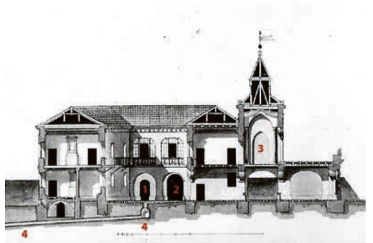
Замок Бип. Разрез. Фиксационный чертеж. 1 — конюшни; 2 — каретные сараи; 3 — место мальтийской капеллы; 4 — коллектор («подземный ход»)
