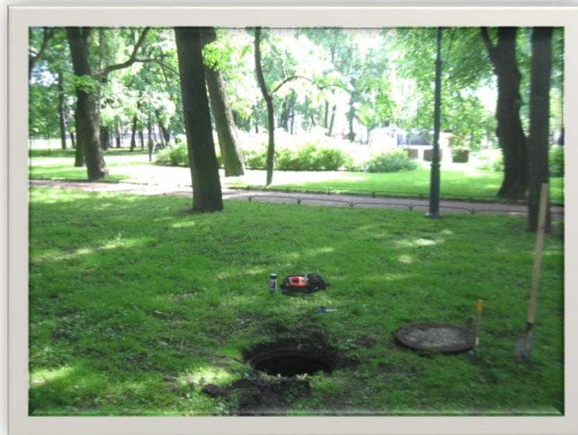
Глубинный репер - нивелирный репер специальной конструкции (основание которого устанавливается на плотные, динамически устойчивые грунты), служащий высотной геодезической основой для выполнения геодезических наблюдений за деформациями зданий, сооружений и земной поверхности.
