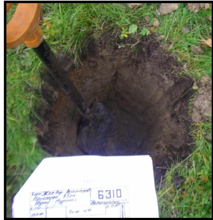
Пункт был утрачен в 2013 году при благоустройстве территории (сверху был насыпан грунт высотой 1м, центр пункта при проведении работ был поврежден).
