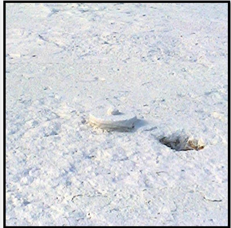
**Гравиметрическим пунктом** называется точка на земной поверхности, в которой измерено ускорение силы тяжести и определены геодезические координаты, в т.ч., высота.
